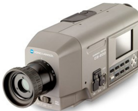
Figura 2. Colorímetro (CS-200 da Konica Minolta) utilizado para medir a luminância das amostras.
