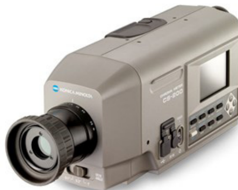
Figura 2. Colorímetro (CS-200 da Konica Minolta) utilizado para medir a luminância das amostras.
