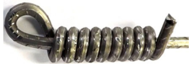
Figura 1. Detalhamento do ensaio de enrolamento realizado no material.
