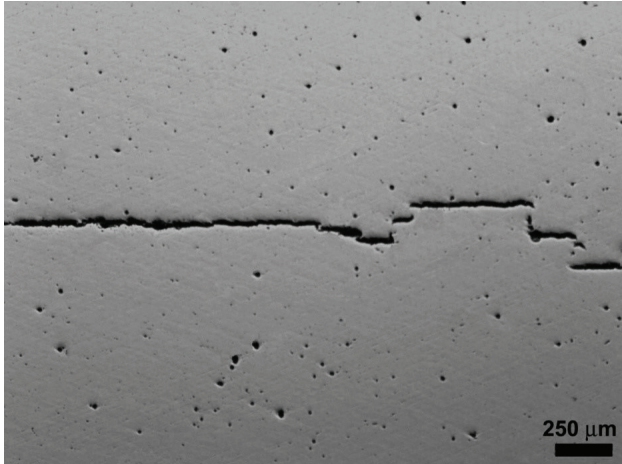
Figura 2. Fratura induzida por hidrogênio em aço de um tubo API 5L X65 exposto a meio ácido ( Solução A [21]), aumento 100X, polimento 1 μm, sem ataque metalográfico, microscopia óptica.
