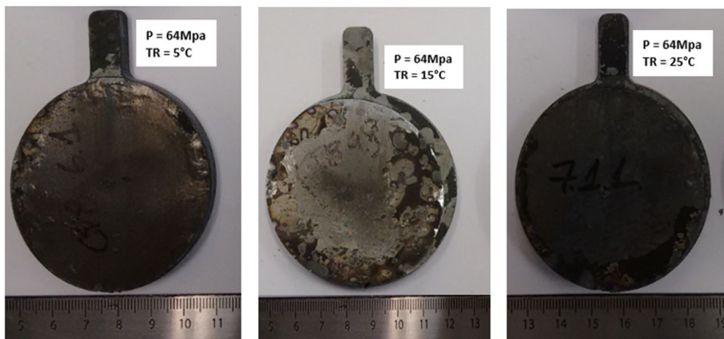
Figura 6. Vista de topo das superfícies dos corpos de prova após processo de presshardening .
