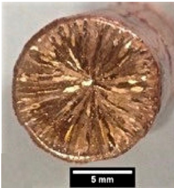
Figura 3. Macroestrutura da matéria prima utilizada (vergalhão).
