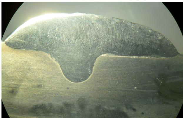
**Figura 4.** Metodologia utilizada para dimensionar o MS na Macrografia do cordão de solda do AISI 316L.
