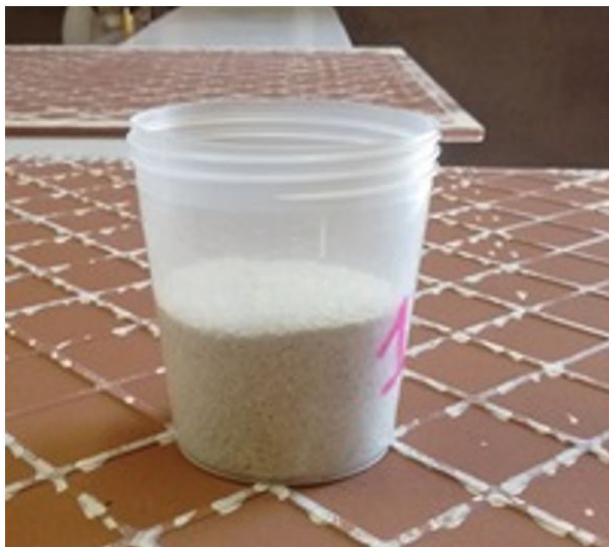
Figura 4. Rejeito de caulim utilizado na confecção da geotinta.
