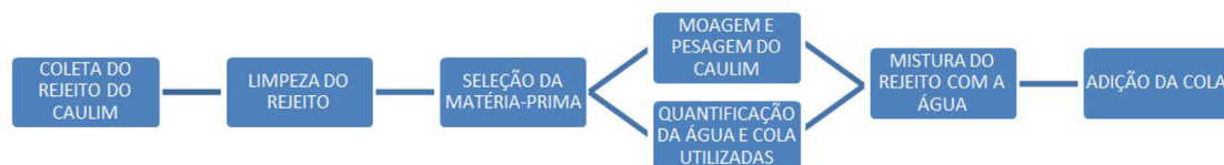
Figura 2. Etapas para a confecção da geotinta.
