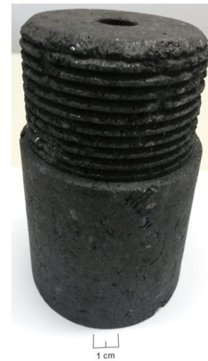
Figura 2. Representação esquemática e foto ilustrativa do corpo de prova de bloco de carbono para o teste de penetração.
