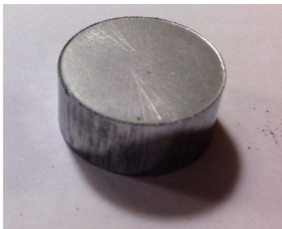
Figura 5. Amostra obtida por compactação do pó da liga BiSbZn.
