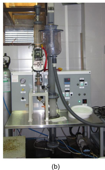
Figura 1. Desenho esquemático do sistema montado (a) e foto da coluna de flotação acoplada ao APBS (b) para os estudos de determinação do tamanho de bolha.
