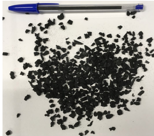
Figura 2. Detalhe da borracha de pneu triturada injetada no forno elétrico.
