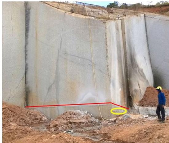
**Figura 4.** Em vermelho a “boca de lobo” já cortada com fio diamantado, com furos horizontais em amarelo onde será inserido explosivo, para realizar o desmonte da cunha e promover o tombamento da bancada ultra-alta [6].
