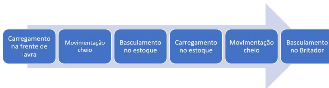
Figura 1. Fluxos de movimentação entre as frentes de lavra e britagem.
