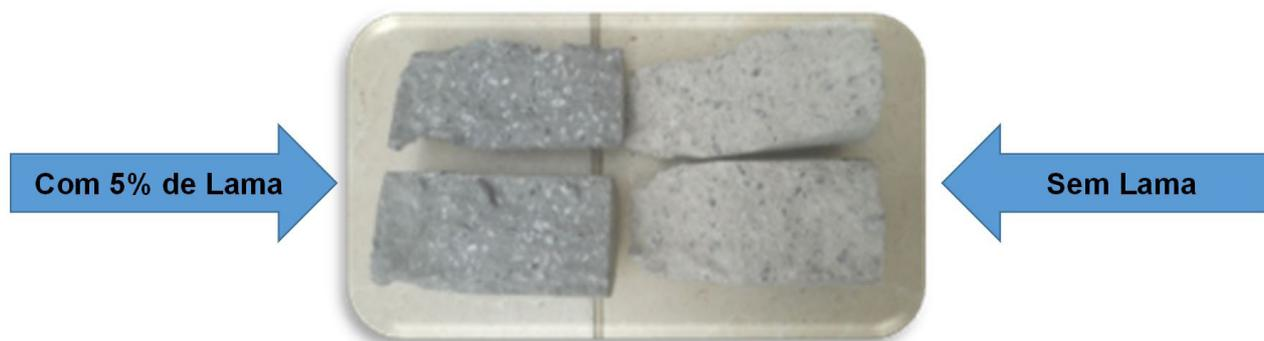
Figura 7. Comparação na tonalidade dos corpos de prova com 5% de lama fina de aciaria e sem adição de lama fina de aciaria.
