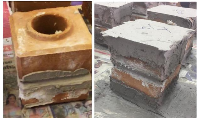
Figura 1. (a) Meio tijolo assentado com argamassa; (b) Capeamento superior e inferior com argamassa.
