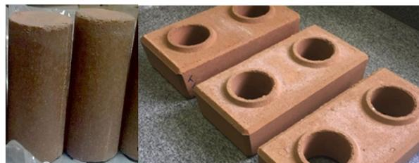
**Figura 4.** Imagem do corpo de prova cilíndrico após prensagem (à esquerda) e do tijolo vazado (à direita), após a cura.
