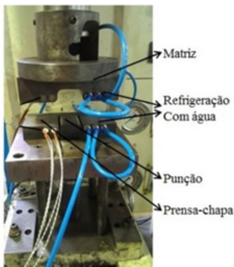
Figura 3. Ferramental utilizado na estampagem das amostras.
