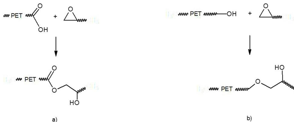
**Figura 3.** Reações dos grupos terminais carboxila e álcool do PET com o anel epóxi do GMA [18,19]. (a) Reação de esterificação; (b) Reação de eterificação.
