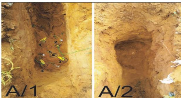
**Figura 7.** A/1 – configuração A carregada; A/2 resultado da detonação.
