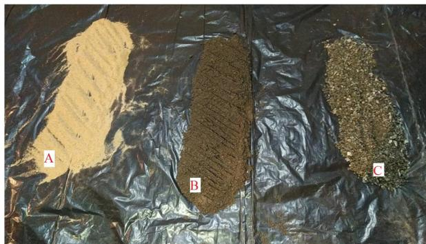
**Figura 1.** Materiais utilizados para confecção dos corpos de prova (A) areia comercial; (B) rejeito de minério de ferro; (C) brita 0.
