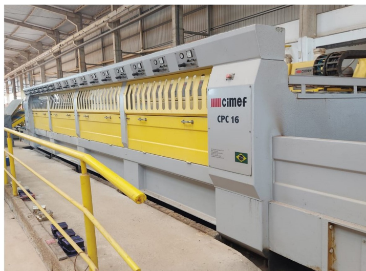
Figura 2. Exemplo de politriz utilizada no processo de beneficiamento final de rochas ornamentais.
