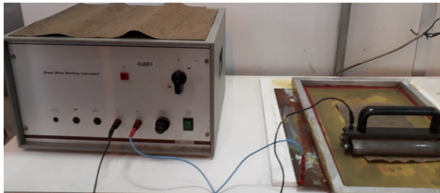
Figura 2. Processo de criação da malha de círculos nos blanques.
