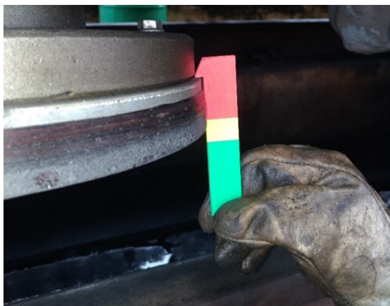
Figura 9. Gabarito de rebolo (esquerda) e comparação entre novo e usado (direita)
