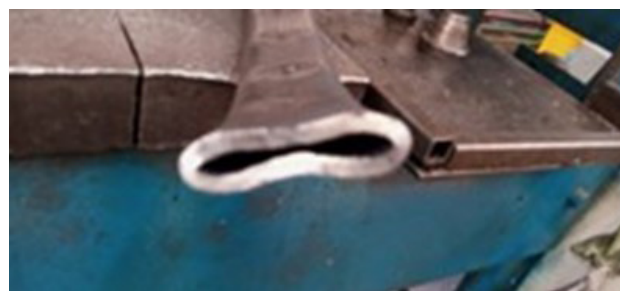
Figura 2. Ensaio de Achatamento 12 horas com o tubo levado ao estado limite para verificar a resistência da solda.
