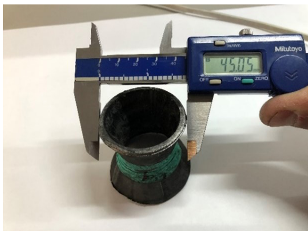
Figura 1. Medição realizada após o ensaio de alargamento da Amostra 1.
