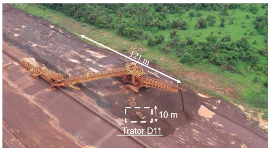
Figura 1. Sistema de operação de lavra contínua para estéril em pilha de disposição de estéril controlada.
