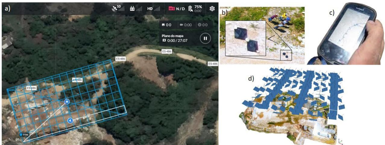
**Figura 3.** Etapas do levantamento. a) plano de voo do local de estudo no aplicativo *Drone Deploy*; b) pontos de controle; c) GPS usado; d) posicionamento das imagens.
