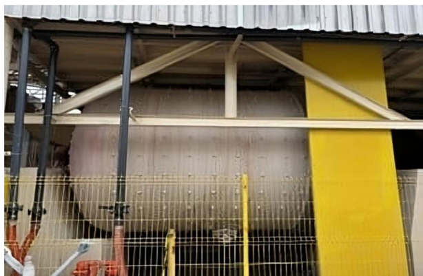
Figura 2. Moinho do processo atual (denominado processo 1), usado para misturar o granito moído com a barbotina de argila plástica, filito e os caulins. O moinho possui revestimento de borracha e corpos moedores mistos.
