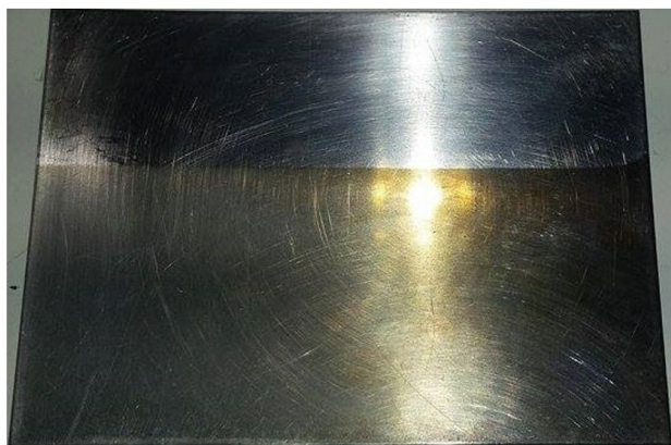
Figura 3. Peça em aço inoxidável após ensaio em Célula de Hull.
