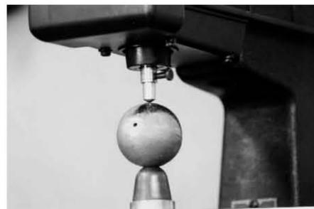
Figura 3. Medição de dureza da superfície da bola
