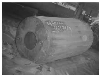
Figura 7. Lingote "oco" logo após a desmoldagem.
