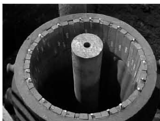
Figura 6. Fotografia da montagem parcial do dispositivo. Lingoteira 1260.
