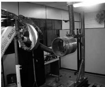
**Figura 7.** Tubo posicionado para soldagem com o robô antropomórfico.
