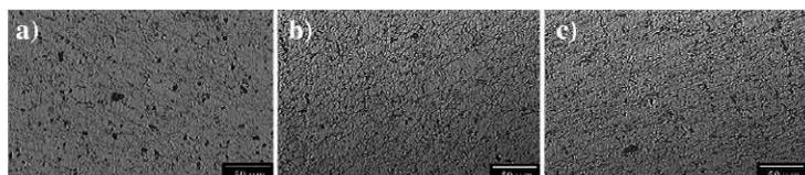
Figura 6. Amostras extrudadas mostrando grãos seguindo o sentido da deformação, a) 60°, b) 90° e c) 180°.
