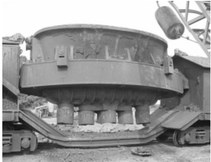
Figura 2. Pote de Escória acoplado ao vagão ferroviário.
