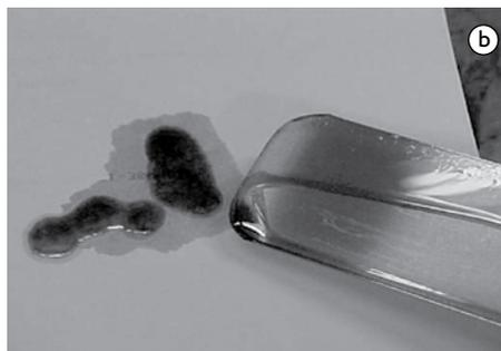
**Figura 3.** Resíduos que se desprenderam durante a laminação a frio no laminador do Centro de Pesquisa a) sobre o cilindro; e b) sobre a amostra.
