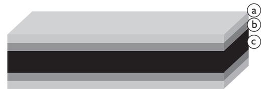
Figura 4. Representação esquemática do overcoating na tira zincada.<sup>(3)</sup> (a) Overcoating (excesso); (b) Revestimento definido pela norma; e (c) Metal base (aço).
