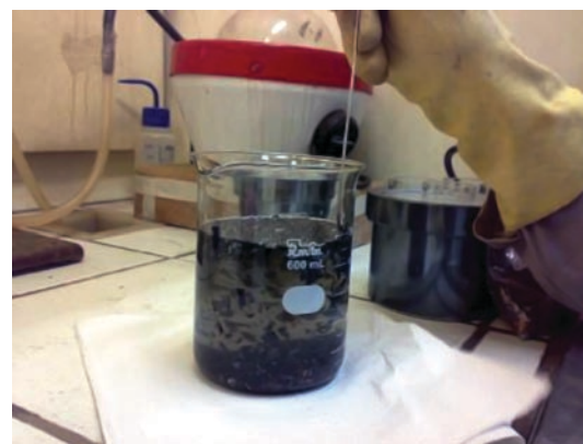
Figura 3. Agitação com vareta de aço inoxidável.
