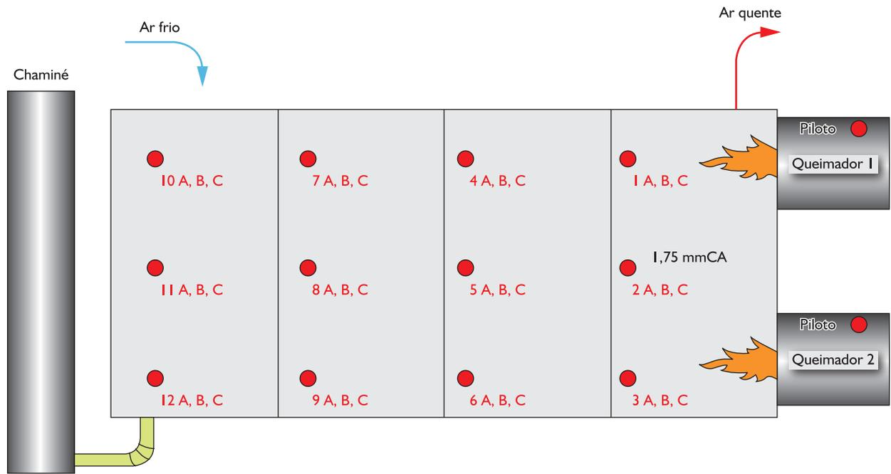
Figura 4. Vista superior dos pontos de medição.<sup>(7)</sup>
