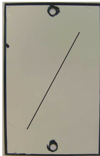
Figura 1. Corpo-de-prova com bordas e regiões de furos protegidas com tinta bicomponente epóxi poliamida e com danificação mecânica intencional na película seca de tinta.
