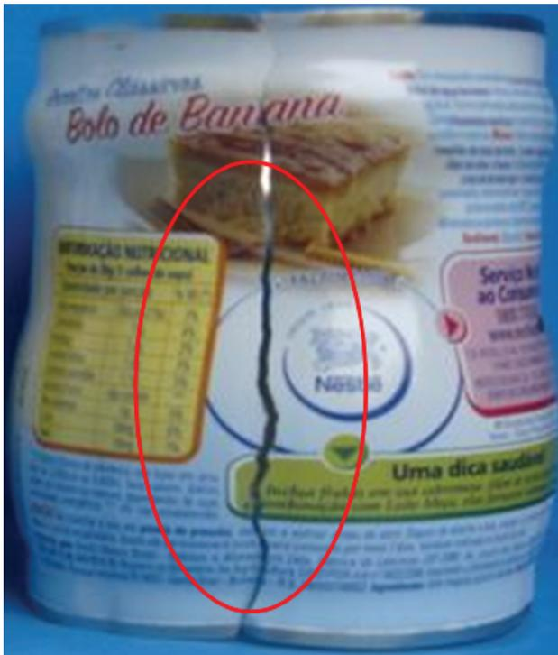
**Figura 1.** Face exterior da lata rompida após seu processo de expansão.
