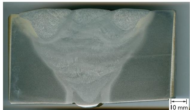
**Figura 3.** Aspecto macrográfico da junta soldada com aporte térmico de 3,5 kJ/mm. Processos de arame tubular e de arco submerso.
