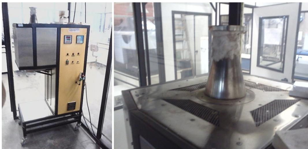
**Figura 1.** Forno tubular vertical e detalhe do cone metálico para coleta da poeira gerada.
