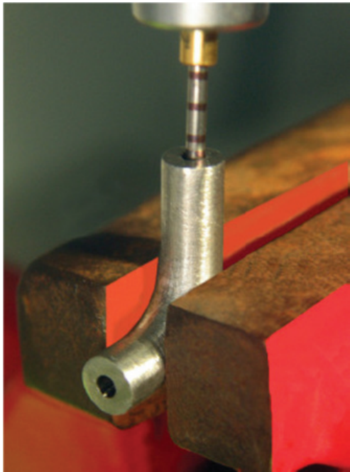
Figura 4. Dispositivo de ensaio em flexão rotativa utilizado por Britto [10].
