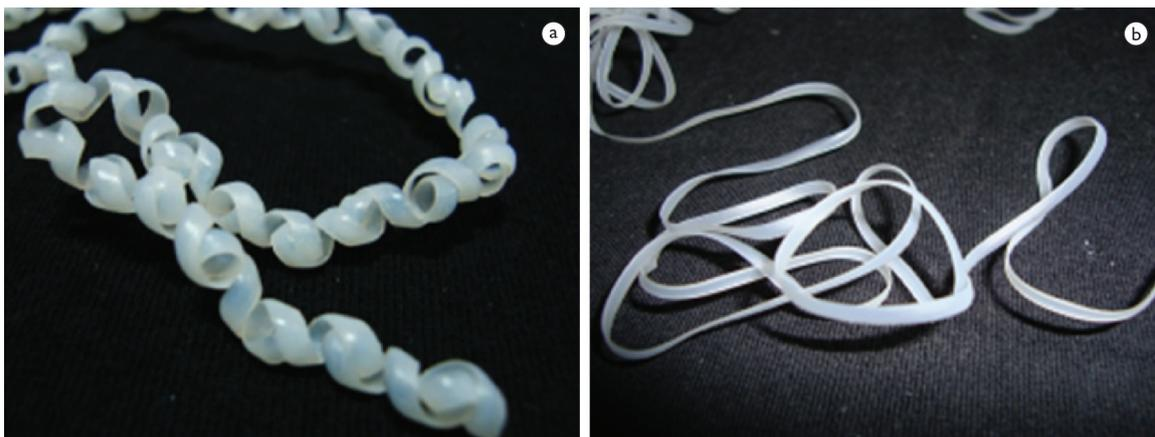
**Figura 14.** Ferramenta TNMG 160408-PF. (a) Com fluido de corte, formando cavacos tubulares e emaranhados; (b) sem fluido de corte, com formação de cavacos em fita longa.
