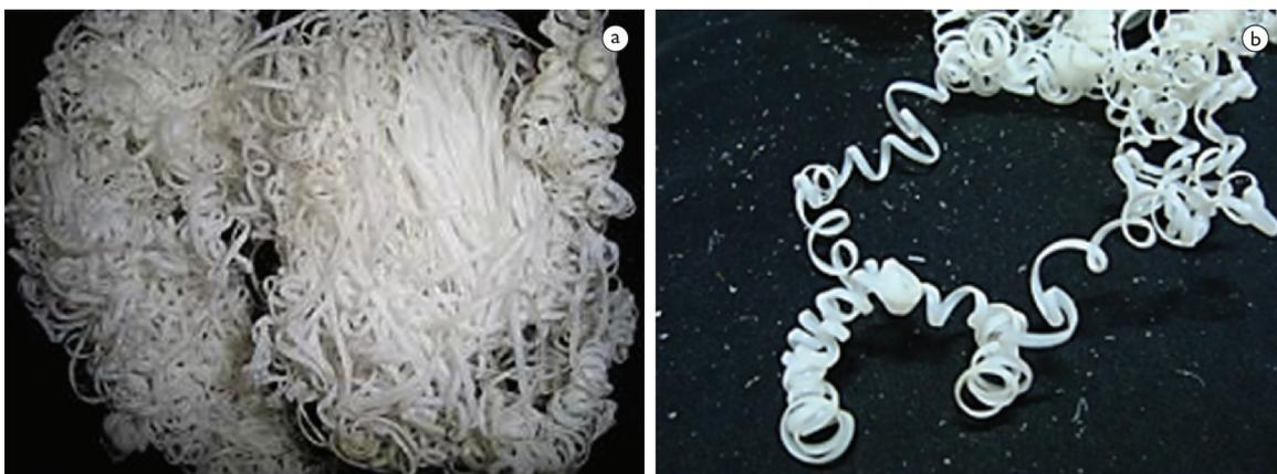
Figura 6. Cavaco em espiral plano e fita emaranhada, (a) Volume total; (b) ampliação de 5x.
