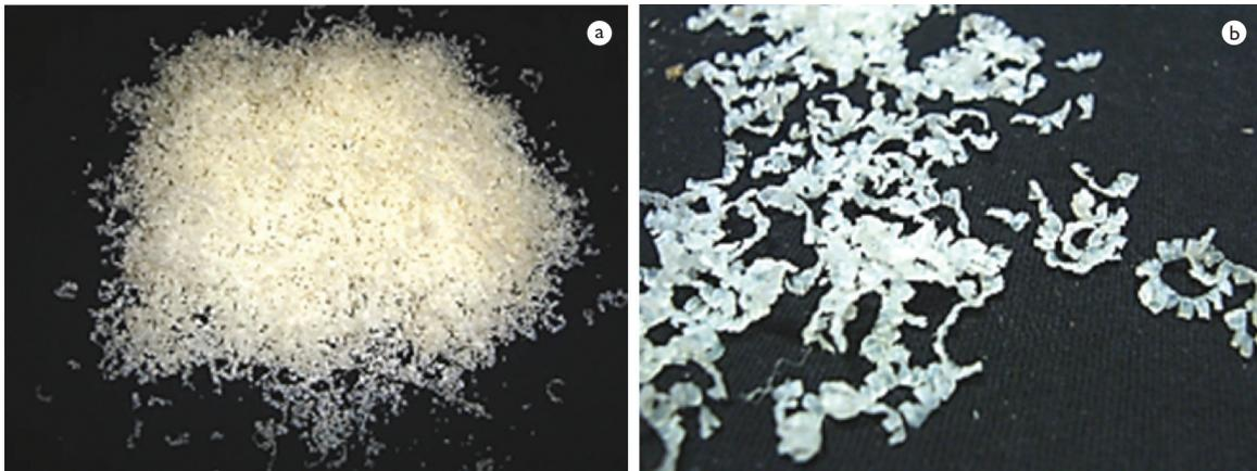
**Figura 11.** Cavaco fragmentado e em arco solto. (a) Volume total; (b) ampliação de 5x.
