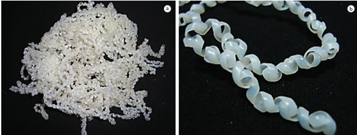
Figura 4. Cavaco em formato tubular emaranhado, (a) Volume total; (b) ampliação de 5x.
