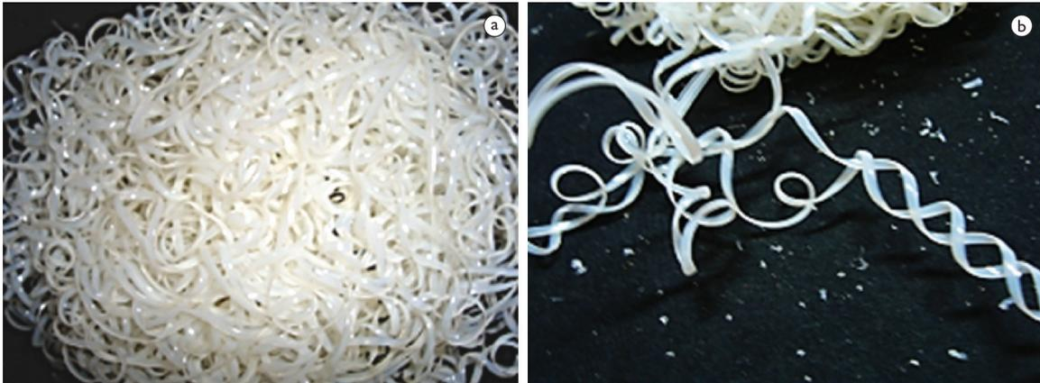
Figura 7. Cavaco em espiral plano e hélice emaranhada, (a) Volume total; (b) ampliação de 5x.
