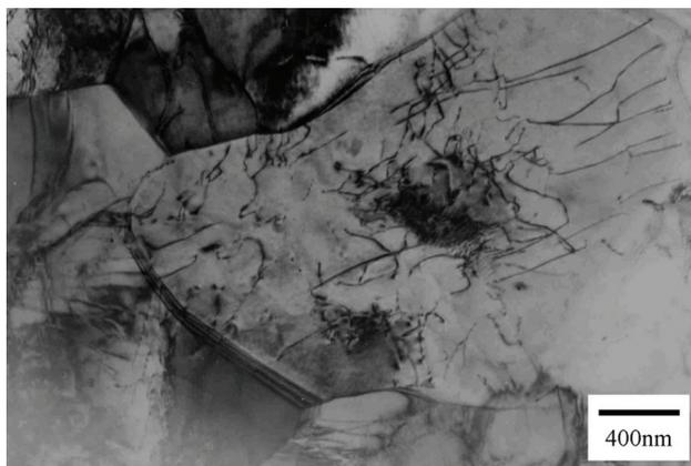
**Figura 4.** Micrografia MET em campo claro mostrando discordâncias em grão de ferrita. Note as franjas de espessura no contorno de grão, muitas vezes usadas para determinação da espessura da lâmina fina no local. Aumento nominal: 35.000 vezes.
